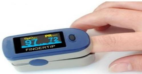
این دستگاه برای سنجش و نمایش درصد اشباع اکسیژن در خون به صورت غیر تهاجمی به کار می رود. اکسی هموگلوبین و دی اکسی هموگلوبین در مقابل نور مادون قرمز و قرمز دارای اختلاف جذب نوری هستند، این اختلاف اساس کار دستگاه های اکسی متری است.
